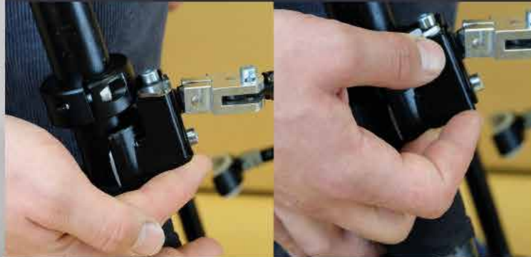
Kupplung auf beiden Seiten in Ring einstecken
